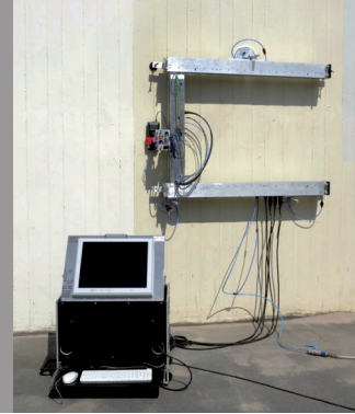
OSSCAR – System und Manipulator zur Prüfung ebener Flächen
