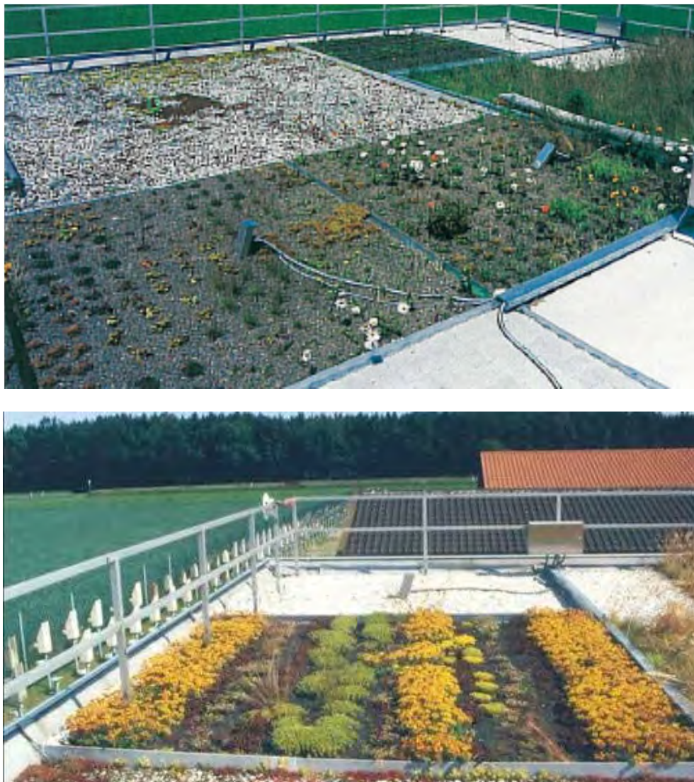
Bild 1: Fotografische Aufnahme der Versuchsfelder am Standort Holzkirchen. Oben: Ansicht von Osten kurz nach dem Aufbau Unten: Ansicht von Süden ein paar Jahre später
