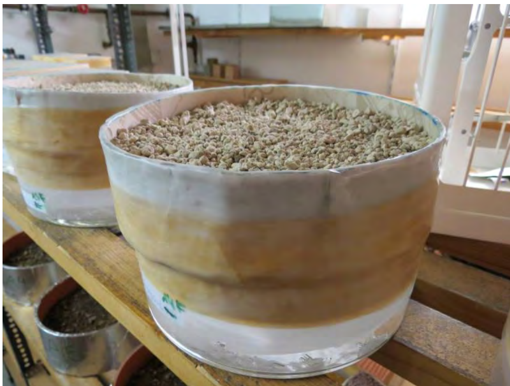
Bild 48: Fotografische Aufnahme des Versuchsaufbaus zur Bestimmung des Diffusionswiderstandes am Beispiel des „Leichtsubstrats Typ L“.
